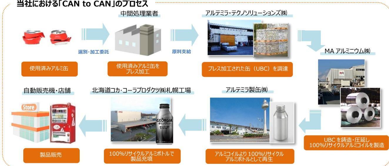
「CAN to CAN」は、中間処理業者がプレス加工した使用済みアルミ缶（UBC）をアルテミラ・テクノソリューションズ(株)が調達し、MA アルミニウム(株)が飲料用アルミ缶原料としてアルミコイルを製造し、アルテミラ製缶株式会社が100%リサイクルアルミボトルとして再生、当社工場でのアルミボトル製品の容器に使用するという取り組みです。
